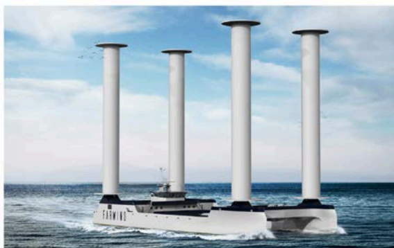
1 - Navire-énergie développé par Farwind Energy pour la production d'hydrogène en mer
